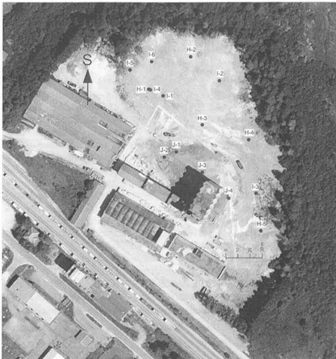
Slika 3 Lokacije uzimanja uzoraka iskopa (I), bušenja (H) te uzoraka crnih hrpa (J)
