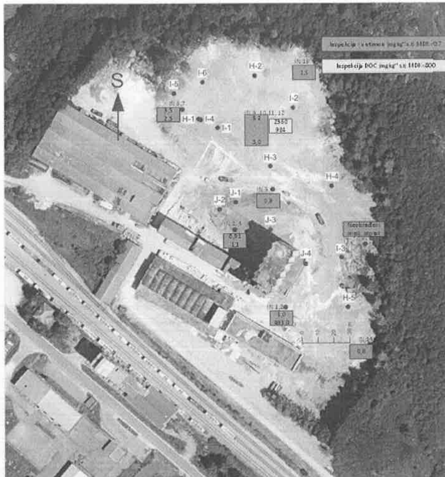
Slika 58 Vrijednosti parametara testa procjeđivanja koji odstupaju od zahtjeva za neopasan otpad (inspeksijski nalaz)
