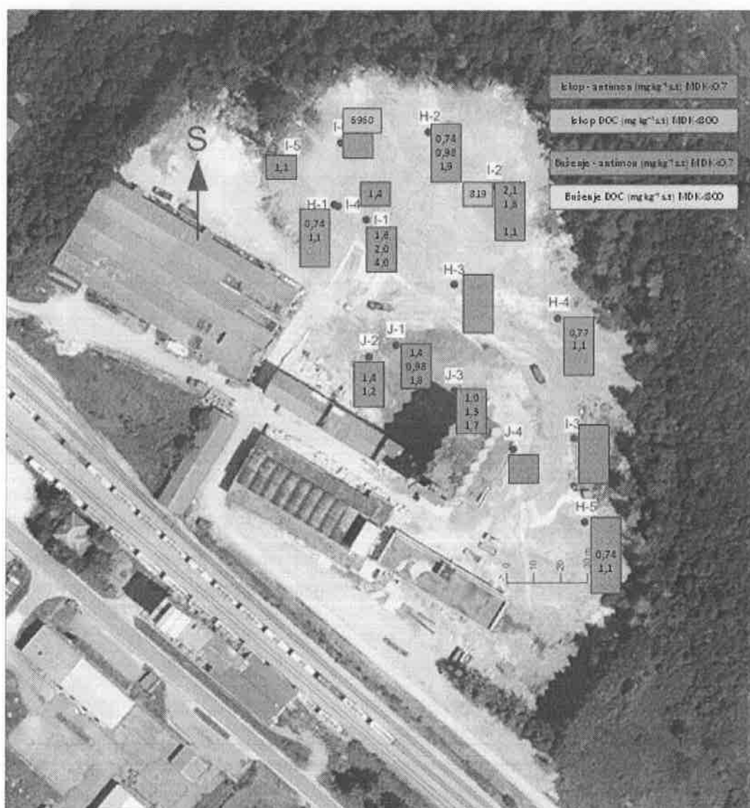
Slika 57 Vrijednosti parametara testa procjeđivanja koji odstupaju od zahtjeva za neopasan otpad (bušenje, iskop i crna hrpa)
